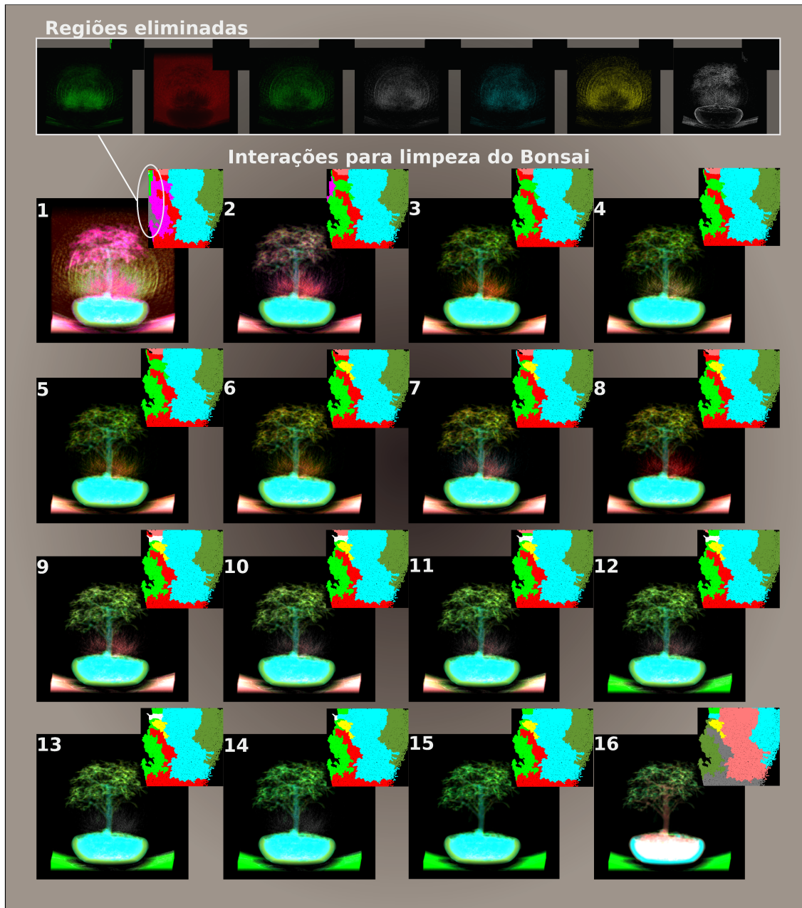
Figura 4.11: Esquema com passo a passo para visualização do bonsai, primeiramente eliminando as regiões com ruído, em seguida inicia-se as subdivisões, eliminando os ruídos ainda presentes e finalmente ajusta-se as cores e opacidades.
