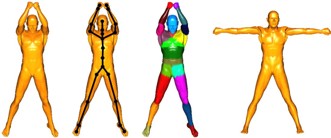
Figura 5.4: Deformação de um modelo 3D usando uma abordagem guiada por esqueletos. O modelo é colocado numa pose onde é possível animá-lo usando movimento capturado.
