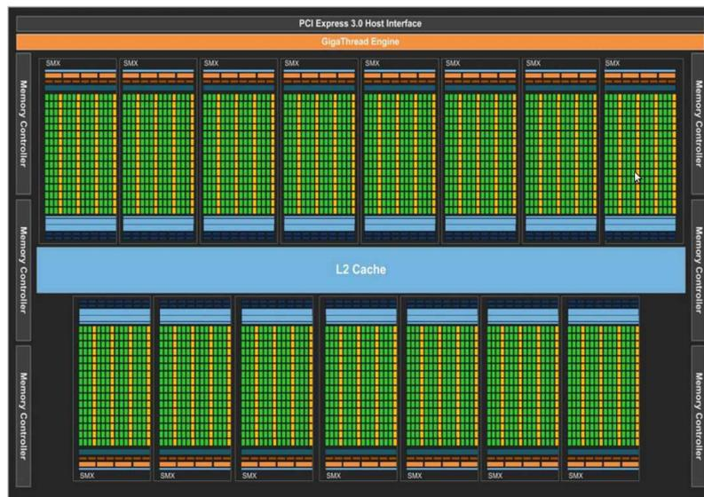
Figura 2.2: Arquitetura das GPUs NVidia Kepler
