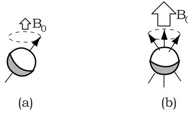
Figura 4.6: Efeitos do campo magnético sobre a frequência de precessão.
