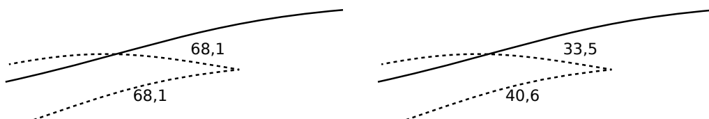
Figura 3.9: Comparativo entre a distância de Hausdorff e a distância paramétrica. Os valores indicam as distâncias entre a curva de cima (linhas contínuas) com cada curva de baixo (linhas tracejas). À esquerda: utilizando a distância de Hausdorff. À direita: utilizando a distância paramétrica.
