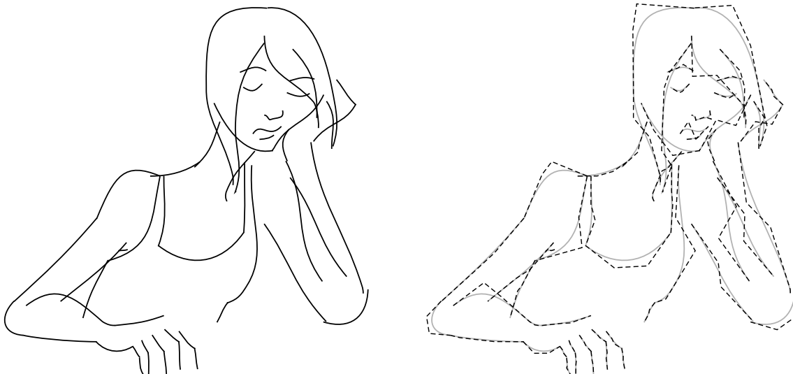
Figura 3.7: Desenho composto por diversas curvas. À esquerda: visualização apenas das curvas de Bézier. À direita: visualização do polígono de controle (linhas tracejadas) sobreposto às curvas de Bézier (em cinza).
