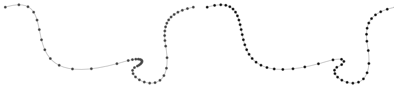
Figura 3.12: Amostragens diferentes para uma mesma curva. À esquerda: amostragem usando a parametrização com divisão uniforme do espaço de parâmetros. À direita: amostragem usando a parametrização ponderada por comprimentos de arco.
