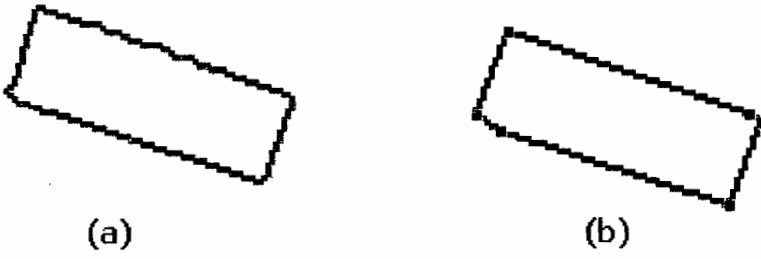
Figura 3.17: (a)Cadeia de pixels. (b)Resultado obtido na aplicação do procedimento de Douglas-Peucker.
