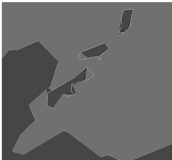
Figura 8.2: Detalhe da aproximação da malha nas ilhas do Lago Superior. As fronteiras originais são representadas por contornos de linha, e a malha final por regiões preenchidas.
